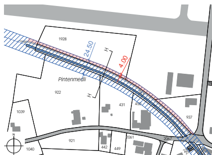
Abb. 50 Planausschnitt Zonenplan Gewässerraum; rot: der zu prüfende Randstreifen
